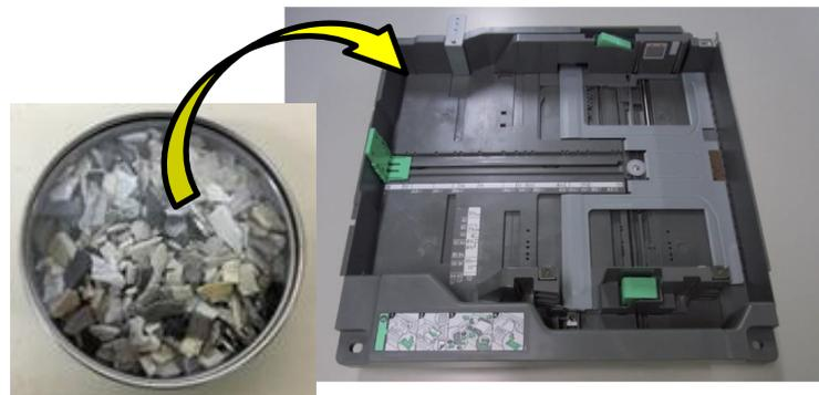
市販回収材を用いた再生材開発
