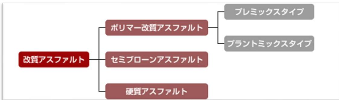
図 2 改質アスファルトの種類
