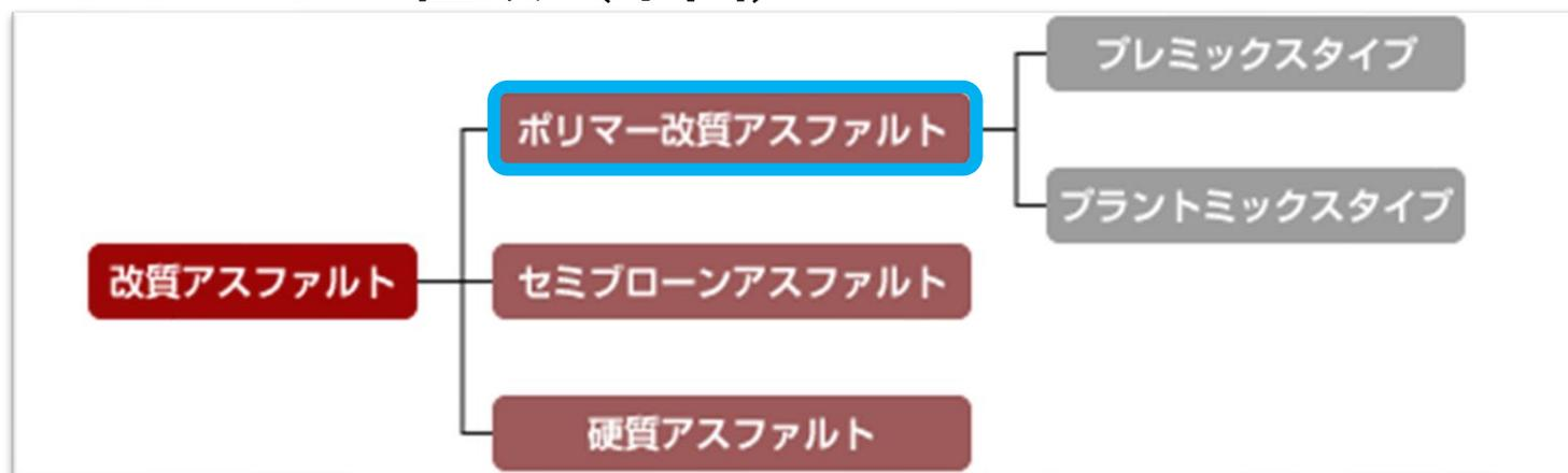
⇒ポリマーを原料とするアスファルト改質材(上記青枠)の中で、ポリマー部分に再生プラスチックを使用した製品が上市されており、資源循環の観点で評価できるものとして、品目追加を行った。
